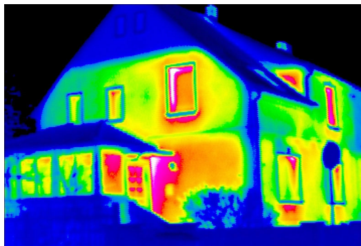
Thermografie-Aufnahme eines Wohnhauses
