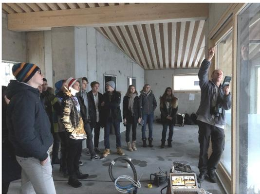
C. Lehner misst den Luftleckagestrom an einem Hebeschiebefenster
